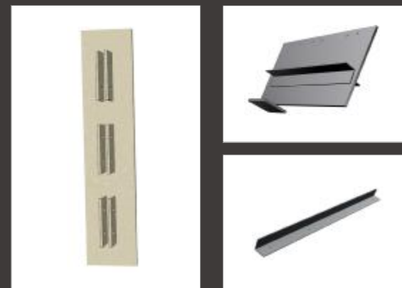
港珠澳大桥口岸屋 面不锈钢钢构件
